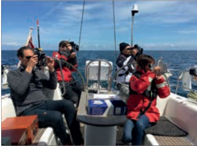
Gleichzeitige Mittagsbreiten-Messung mit verschieden Sextanten
